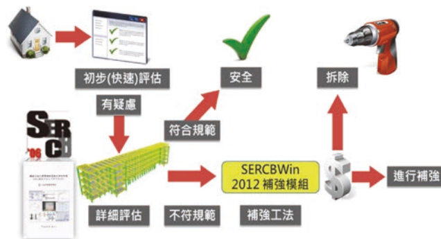
圖 4 建築物耐震能力評估流程
